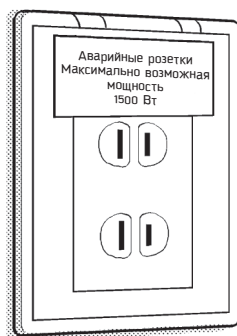
Рис. 5.7. Аварийные розетки на стене
